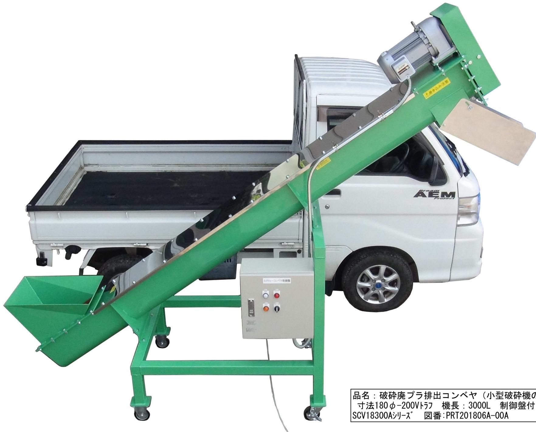
品名：破碎廃プラ排出コンベヤ（小型破碎機の排出より）
